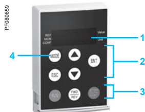
Terminal zdalny z otwartą przesłoną
